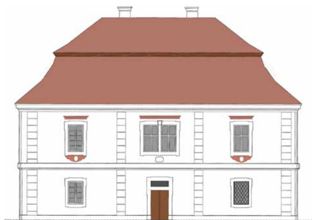
Obr. 11. Žebnice, fara. Návrh řešení severní fasády s pozdně barokními malovanými doplňky. (Převzato od Tomáš Šantavý, projektový ateliér pro architekturu a pozemní stavby, spol. s r. o.; zakreslení detailů P. Vlček, 2008)
